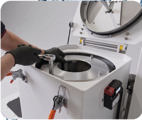
Çamur Kovası Değişimi Sludge Bucket Replacement
