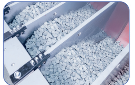
Değiştirilebilir, Uzun Ömürlü Separatör Replaceable, Long-Life Separator
